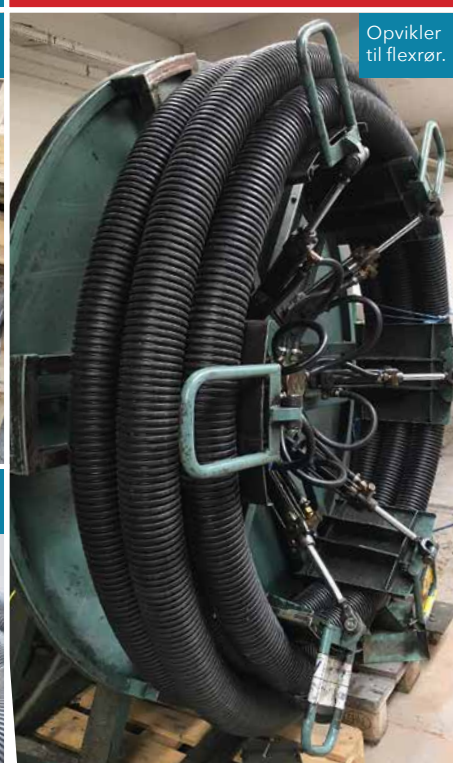
Højtemperaturrør med 40 mm mineraluld.
